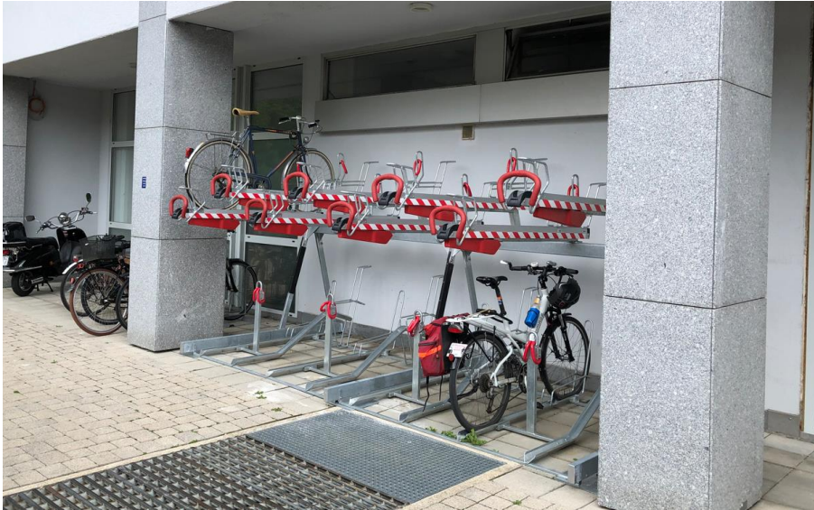
Abbildung 30: Doppelstockparkanlage mit Anschließmöglichkeit des Fahrradrahmens am Rathaus Germering
