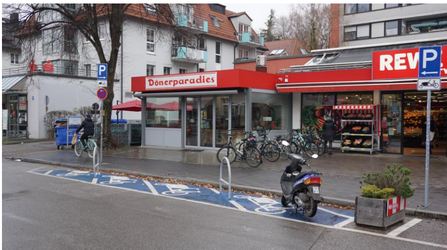
Abbildung 37: Lastenradstellplatz – hier mit kurzem Anlehnbügel
